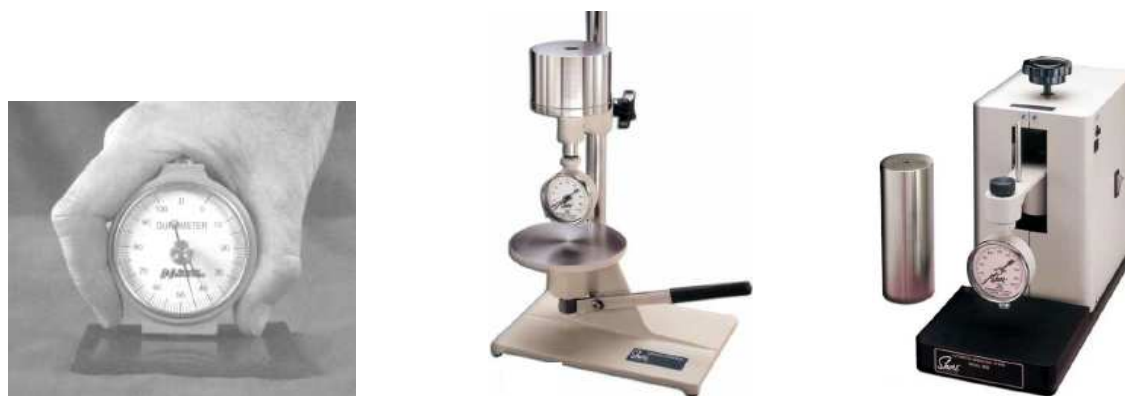
ภาพที่ 12 ตัวอย่างเครื่องทดสอบความแข็งแบบชอร์
