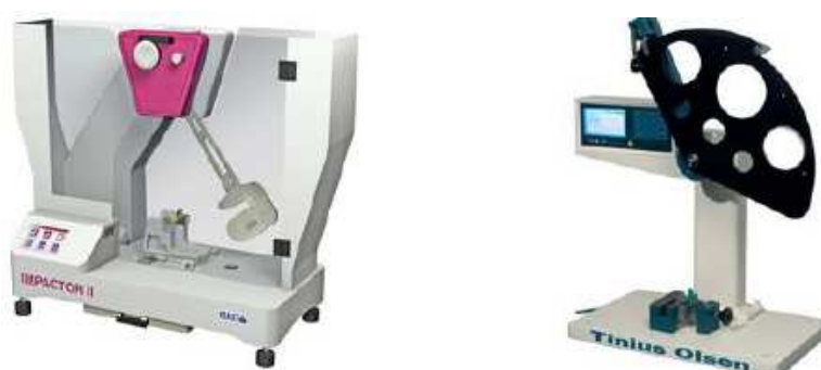
ภาพที่ 17 เครื่องทดสอบการกระแทกแบบค้อนเหวี่ยง
