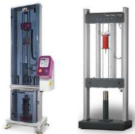
ภาพที่ 18 เครื่องทดสอบการกระแทกแบบปล่อยกระแทกด้วยแรงโน้มถ่วง
